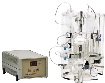
ML176 ランゲンドルフ装置および サーモスタットコントローラ
